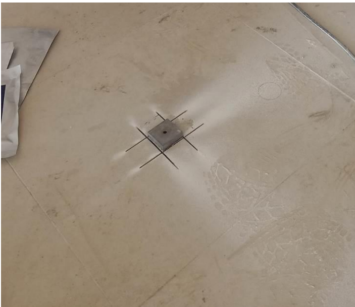
Imagen n°3. Probeta tallada por corte con radial y aplicada la sufridera en obra
